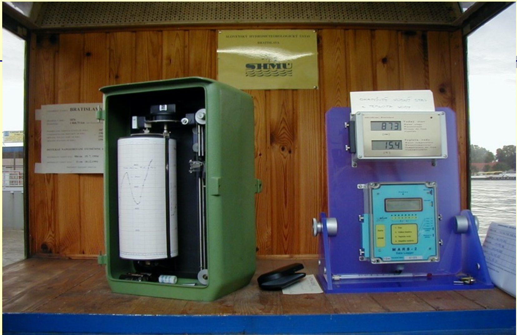
MARS 2 – Устройство автоматической регистрации с датчиком давления
