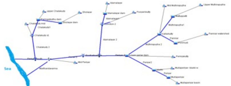
Система гидрологических моделей - модель потока RR + в схеме водосборной сети (HEC-HMS)
